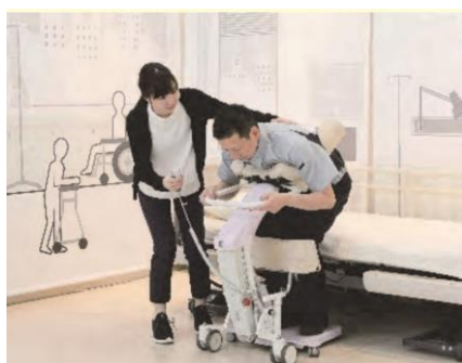
「移乗サポートロボット」 一人で立ち上がることが難しい方に、車いすやトイレへの移乗をサポートするロボット
